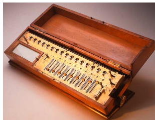
L' arithmomètre de Thomas de Colmar (1820) : 4 opérations arithmétiques. Première machine diffusée à large échelle.
